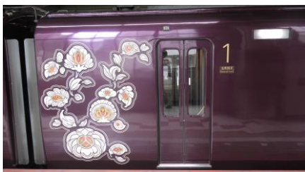
扉は折り戸のまま残っています。 (3号車のみ、引き戸に改造)
