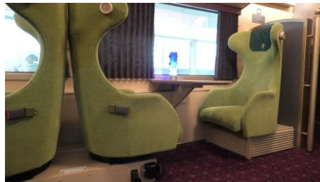
車椅子対応の座席 座席を回転することができ、 固定用のベルトもついています。
